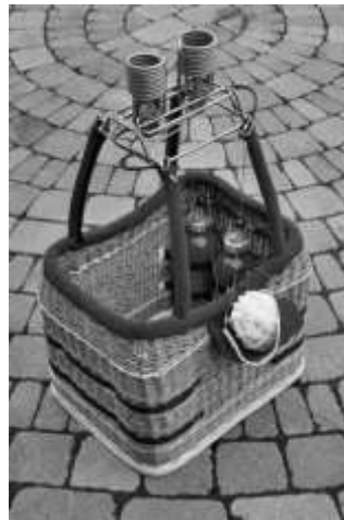
Figura 2.5 – Cesta in vimini con "quadro di carico" e bruciatore
