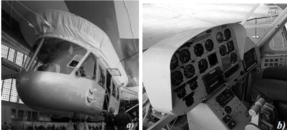
Fig. 2.9 – a) Gondola applicata al ventre del dirigibile; b) cabina di pilotaggio
