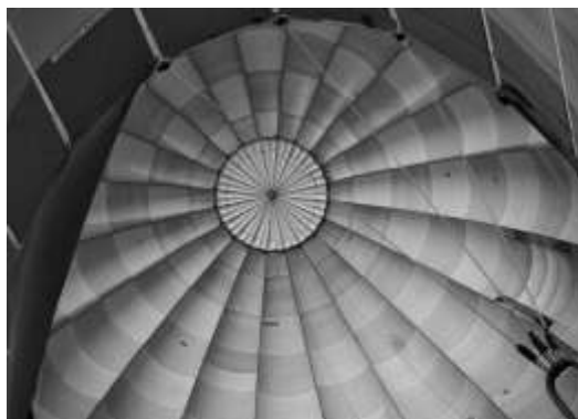
Figura 2.4 – Involucro a spicchi e "anello di coronamento"
